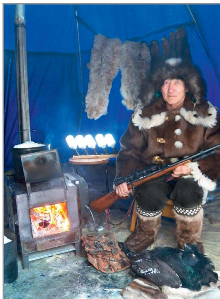
Рис. 13. Походный вариант печи с генератором В25-12 (с правой стороны) в чуме охотника
