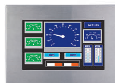
GOT808CV (ПК на автомобиле) 8,5" компьютер с сенсорным дисплеем, со степенью защиты IP66, соответствует требованиям e13
