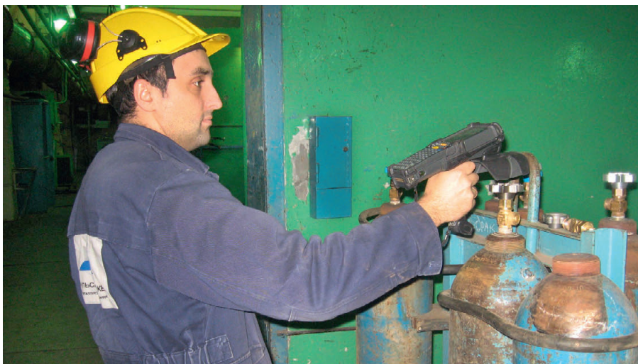
Рис. 4. Считывание данных мобильным RFID-терминалом
