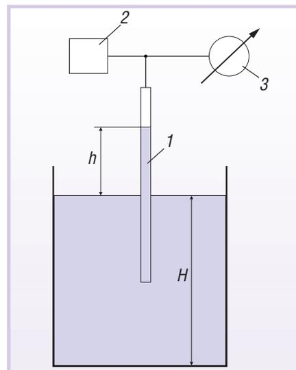
Рис. 5. Вакуумметрический плотномер
