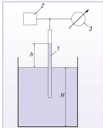
Рис. 5. Вакуумметрический плотномер
