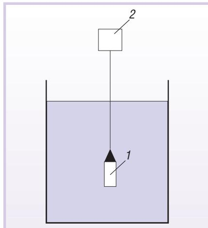
Рис. 4. Поплавковый плотномер
