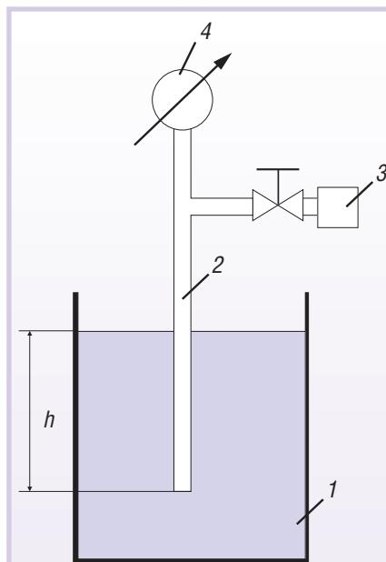
Рис. 1. Гидростатический плотномер с одной трубкой
