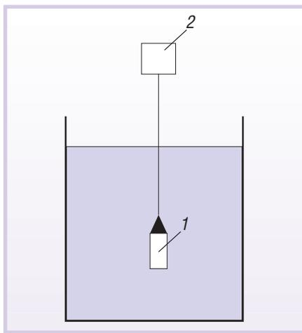
Рис. 4. Поплавковый плотномер
