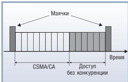
**Рис. 4. Структура суперфрейма с гарантированными временными слотами**
