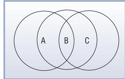
Рис. 3. Иллюстрация «проблемы скрытого узла»
