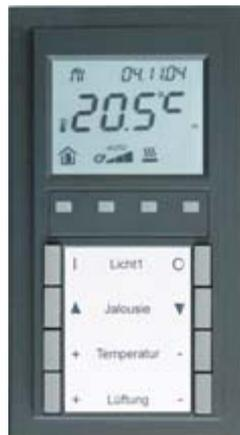
Рис. 11. Комнатная панель управления Thermokon WRF08 2T
