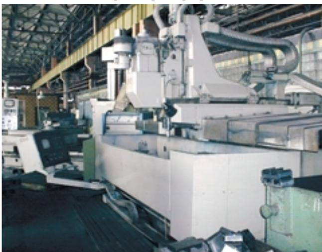
Рис. 1. Большие габариты и наличие подземных коммуникаций затрудняют демонтаж металлообрабатывающих станков
