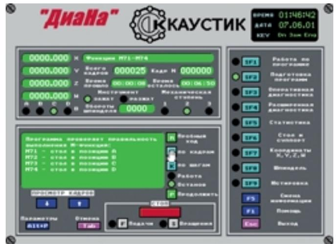
Рис. 7. Экран пользователя для подрежима *Отладка режима Подготовка программ*
