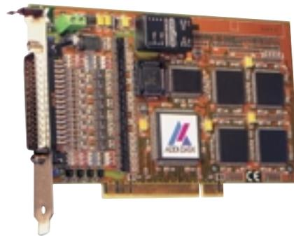
**Внешний вид платы многофункционального высокоскоростного программируемого счётчика с гальванической развязкой АРСІ-1710 фирмы ADDI-DATA**
