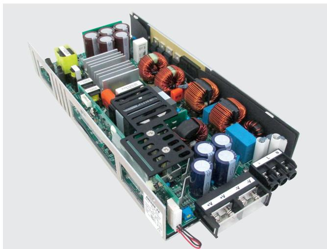
Рис. 9. Внешний вид источника питания серии GXE
