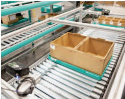
Рис. 5. Комплектовочные лотки на конвейере
