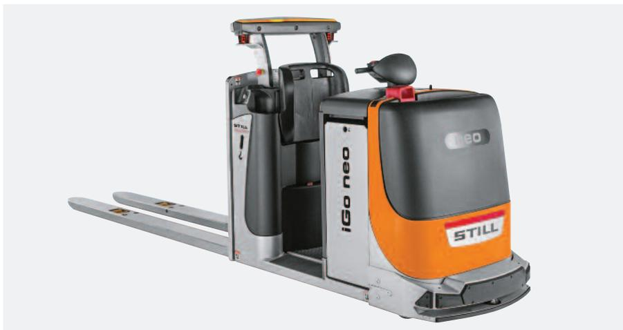
Рис. 6. Сборщик заказов iGo neo CX20, оснащённый лазерными сканерами R2000 2-D
