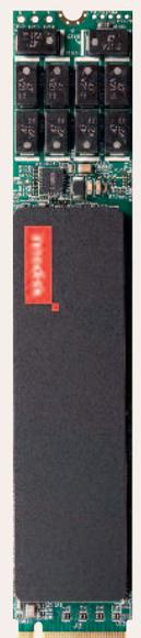
Серия 4TG2-P имеет интерфейс PCIe Gen. 4 с протоколом подключения NVMe 1.4, что обеспечивает накопителям высокую пропускную способность – до 10 раз выше, чем у традиционных SATA-дисков. Таким образом, небольшой бескорпусный накопитель позволит хранить в системе большое количество данных и быстро записывать или обмениваться ими.
