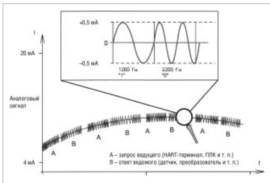
Рис. 3. Кодирование HART-сигнала
