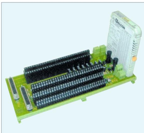
Рис. 7. 32-канальный HART-мультиплексор MUX 2700A с интерфейсом RS-485
