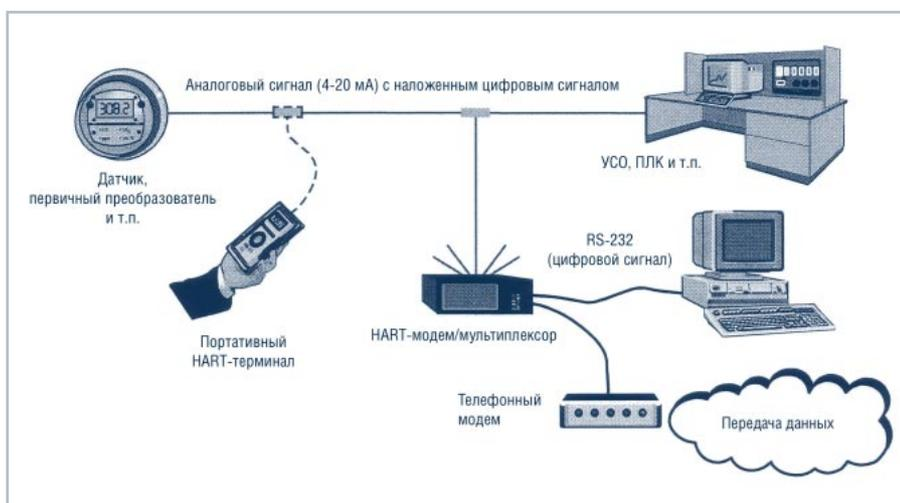
Рис. 2. Типовые HART-компоненты и схема их подключения
