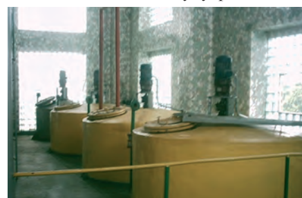
Рис. 2. Технологический участок гидроферментативной обработки крахмала (низкотемпературной варки)
