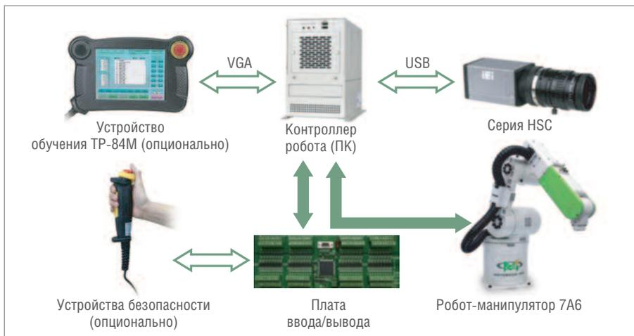
Рис. 2. Архитектура системы позиционирования
