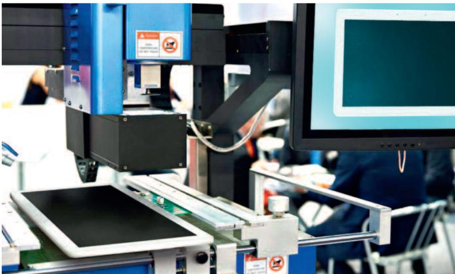
Рис. 6. Проверка качества ЖК-видеопанелей на конвейере
