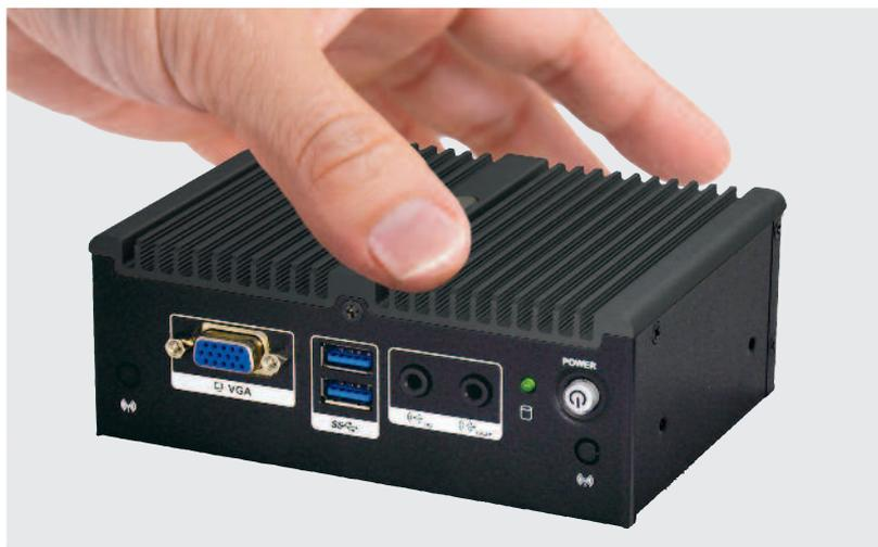
Рис. 10. Ультракомпактная встраиваемая система uIBX-250-BW
