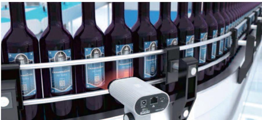
Рис. 5. Промышленная система машинного зрения на конвейере
