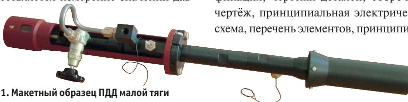
Рис. 1. Макетный образец ПДД малой тяги
