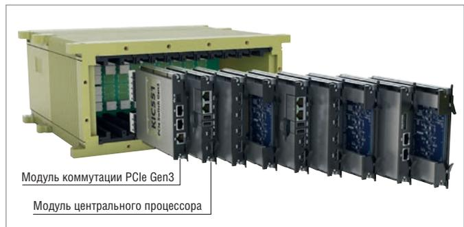
Рис. 3. Модульная структура базового вычислительного блока ГРИФОН
