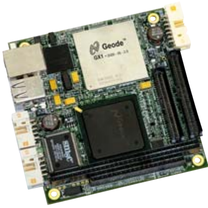
Рис. 1. Процессорная плата CPU686EC-104 в стандарте PC/104 с интерфейсами Ethernet и CAN фирмы Fastwel
