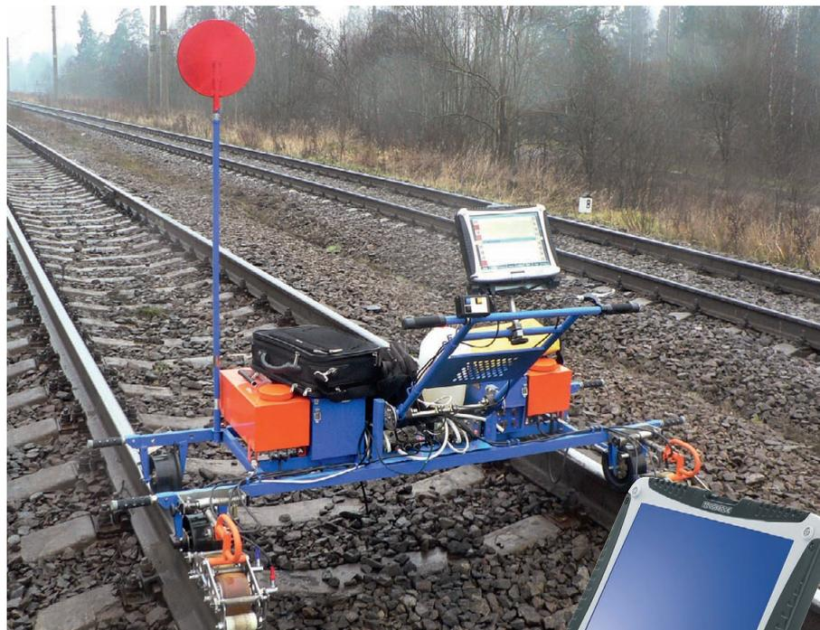
Рис. 5. Дефектоскоп «АВИКОН-14»
