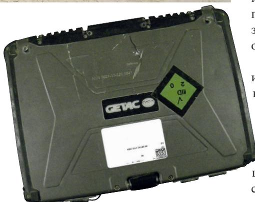
Рис. 8. Крышка ноутбука после попадания камня, отброшенного взрывной волной
