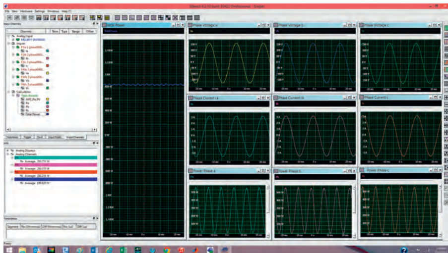
Рис. 61. Расчёт фазовой мощности с использованием значений всех трёх фазовых напряжений и токов в простом примере
