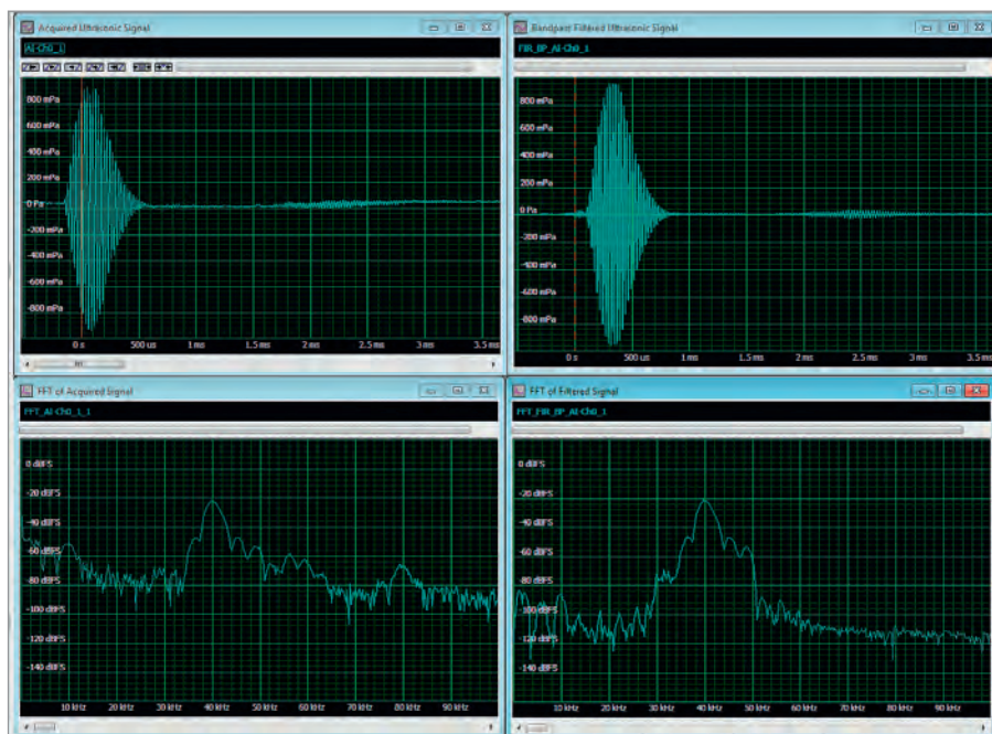
Рис. 56. Результаты применения полосового FIR-фильтра с частотами отсечки от 30 до 50 кГц для ультразвукового сигнала частотой 40 кГц. Исходный сигнал и его FFT находятся в левой части экрана. Справа отображается отфильтрованный сигнал и его FFT. Выравнивание в отфильтрованной базовой линии получено в результате устранения низкочастотной составляющей
