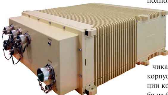
Рис. 6. Базовый корпус для систем с кондуктивным теплоотводом
