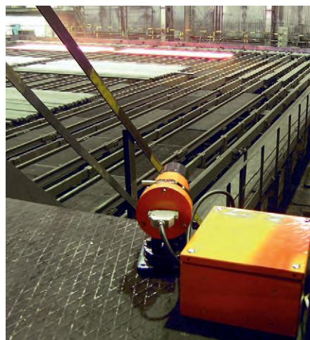
Рис. 4. Размещение оптической камеры при испытаниях
