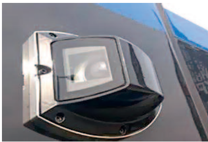
Рис. 10. Наружная установка камер в поезде дальнего следования
