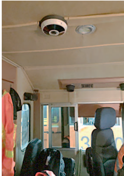
Рис. 9. Установка камер в кабине локомотива
