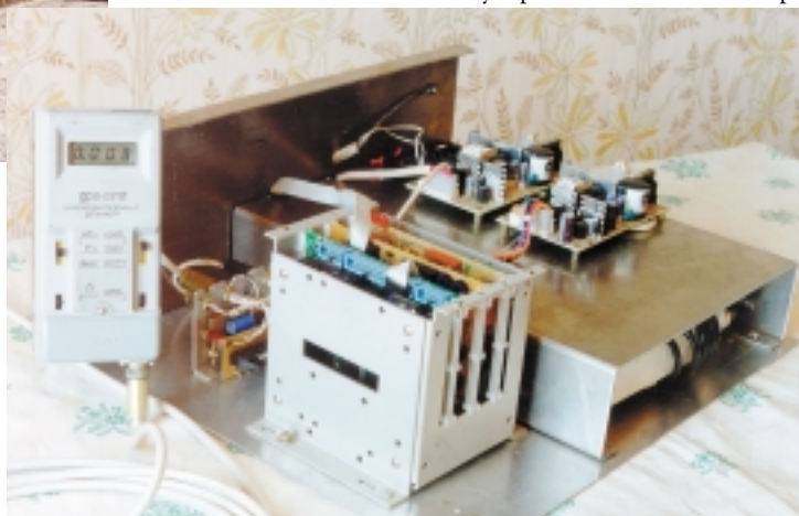
Рис. 5. «Внутренности» вычислительного блока автоматического пункта контроля радиационной обстановки
