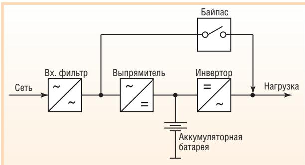
Рис. 8. Топология ИБП с двойным преобразованием энергии
