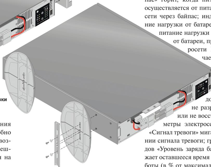
Рис. 3. Установка опор для напольного размещения ИБП
