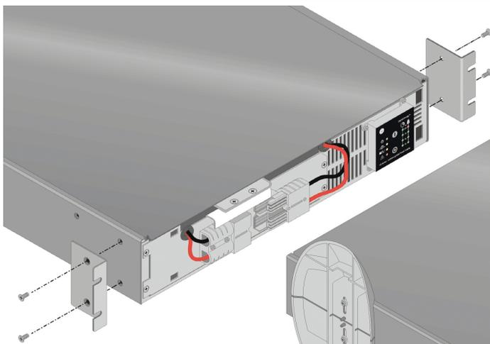
Рис. 2. Монтаж кронштейнов для установки в 19" стойку
