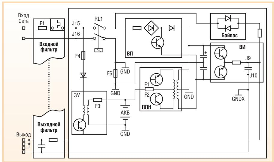
Рис. 9. Структура ИБП серии VH с двойным преобразованием
