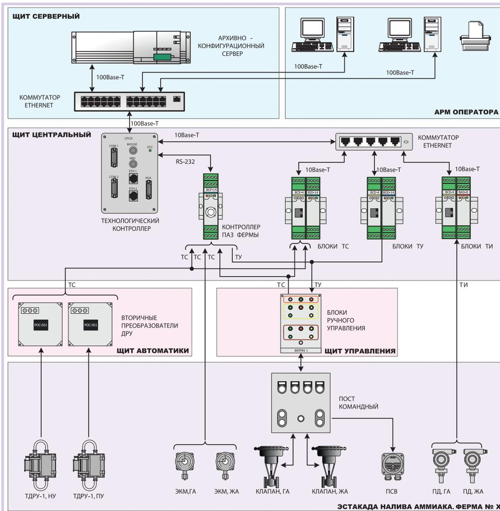
Условные обозначения: ТИ – телеизмерение; ТС – телесигнализация; ТУ – телеуправление; ПАЗ – противоаварийная автоматическая защита; ТДРУ-1 – датчик-реле уровня (ДРУ); НУ – нормальный уровень; ПУ – предупредительный уровень; ГА – газообразный аммиак; ЖА – жидкий аммиак; ЭКМ – электроконтактный манометр; ПСВ – пост сигнальный взрывозащищённый; ПД – преобразователь (датчик) давления.
