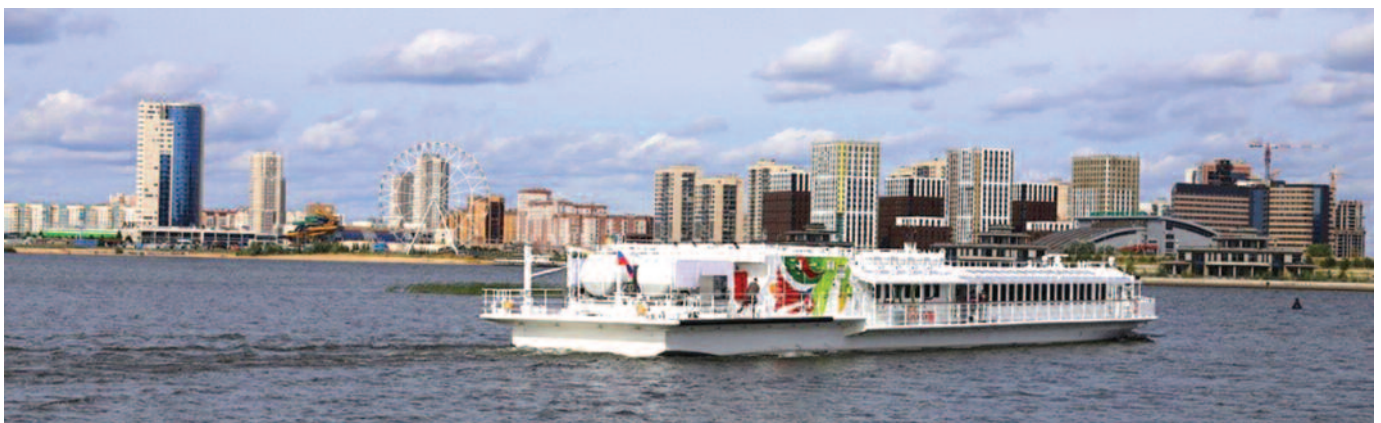
Рис. 1. Судно «Чайка», вид с кормы. Видны ёмкости криогенной бортовой газотопливной системы на палубе
