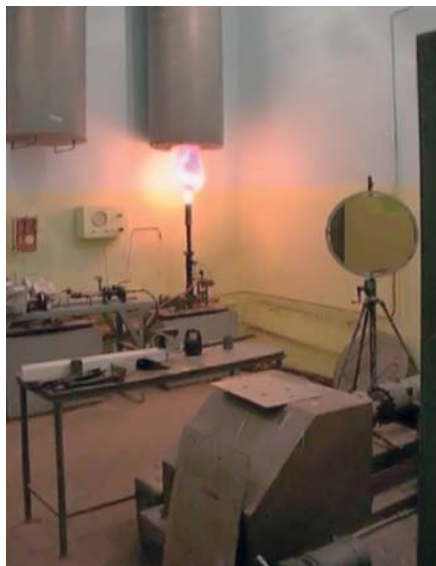
Рис. 6. Работающий макетный образец ПДД с эжекторным насадком
