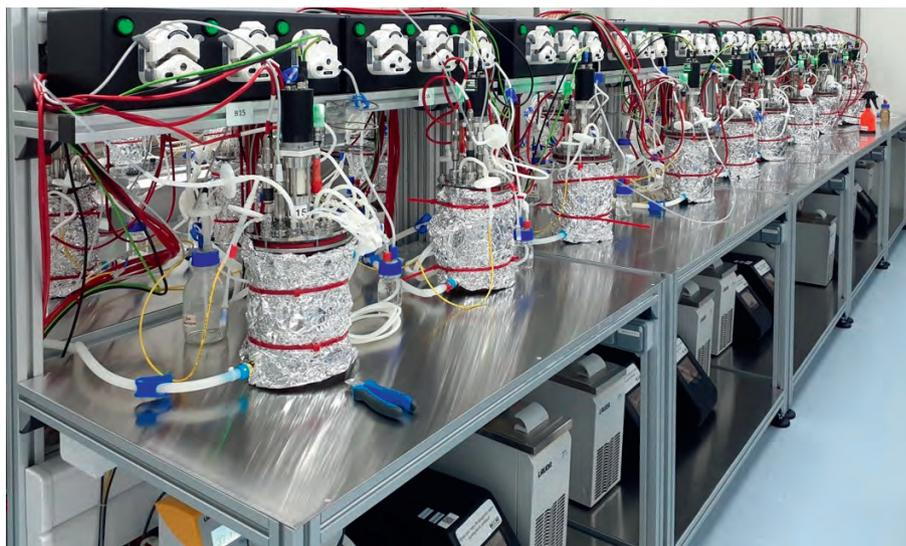
Рис. 6. Процесс культивирования клеток в лабораторных биореакторах
