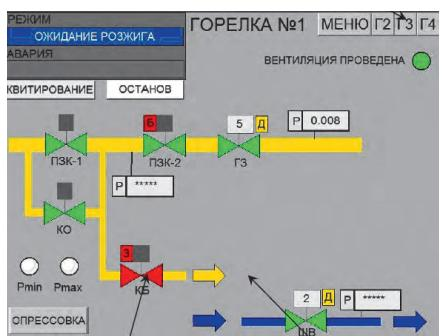
Рис. 7. Мнемосхема подсистемы управления розжигом горелки № 1
