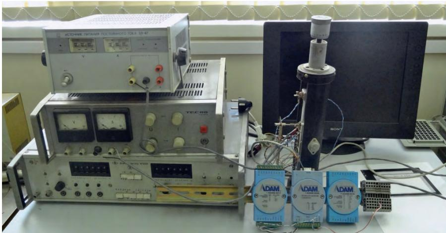
Рис. 8. Лабораторная установка для исследования температурных волн
