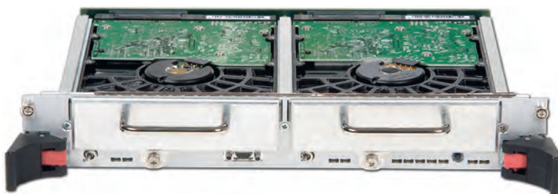
Рис. 4. Модули хранения данных CPC5900/CPC5910 с поддержкой RAID для систем CompactPCI 6U
