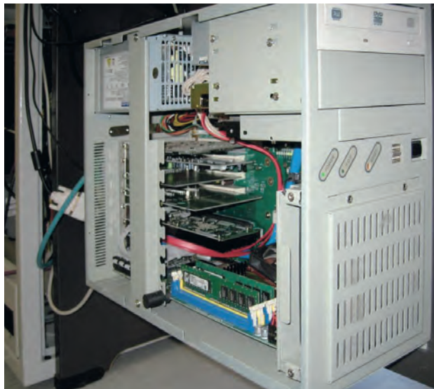
Рис. 4. Системный блок АРМ ШН (боковая крышка корпуса ІРС-6608 снята для демонстрации внутренней конструкции блока)
