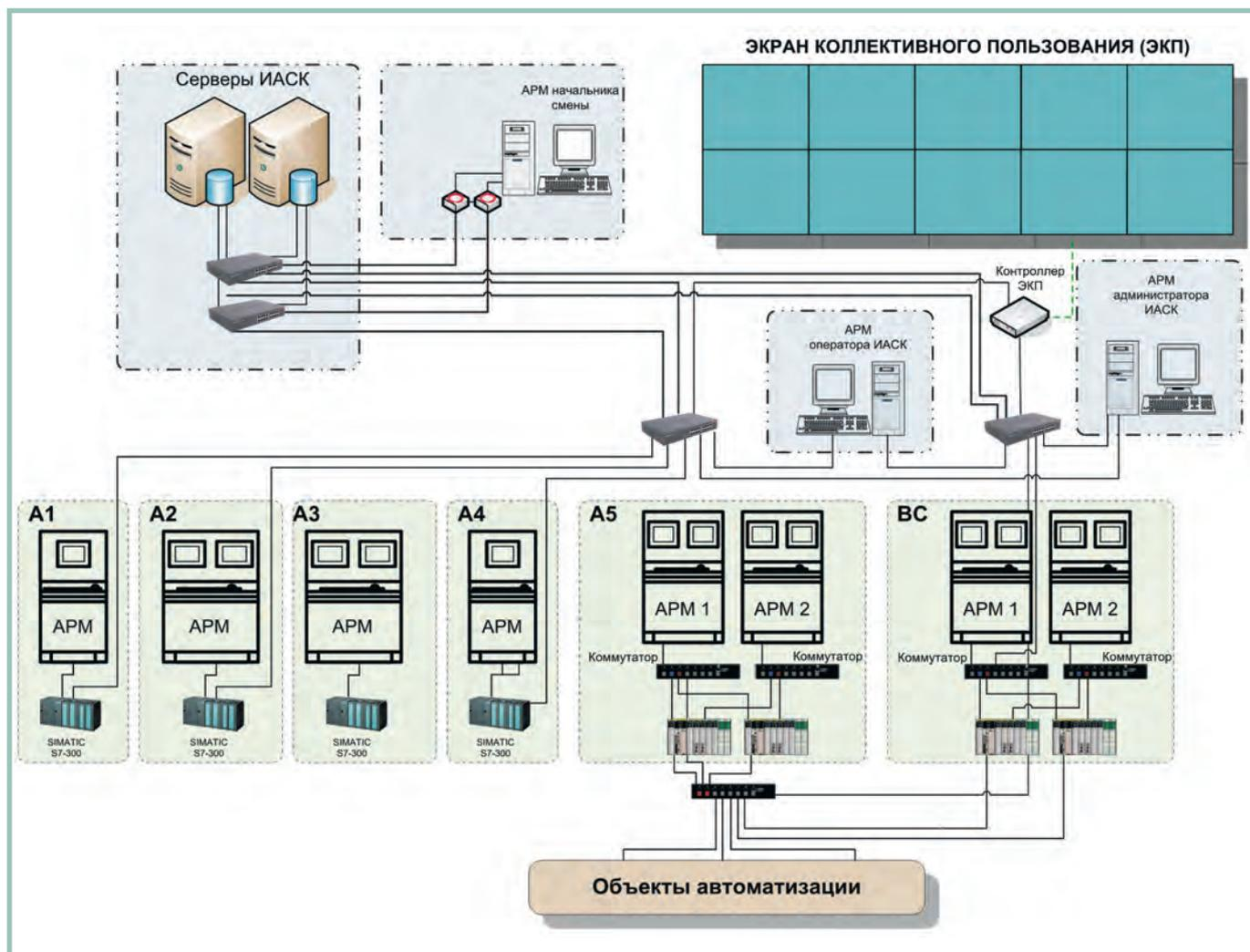
Рис. 1. Структурная схема ИАСК переработки жидких радиоактивных отходов
