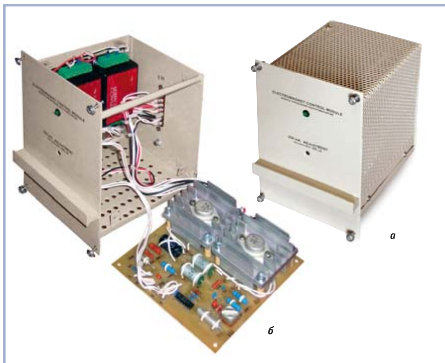
Рис. 3. Модуль управления электромагнитом (МУЭМ): а — внешний вид, б — вид со снятым кожухом и извлечённой электрической платой
