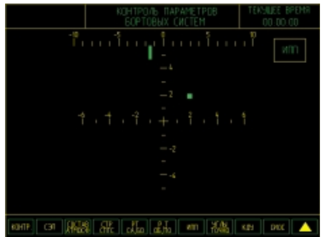
Рис. 5. Отображение параметров ориентации корабля
