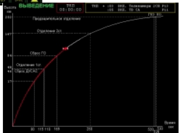
Рис. 6. Отображение программы выведения корабля на орбиту
