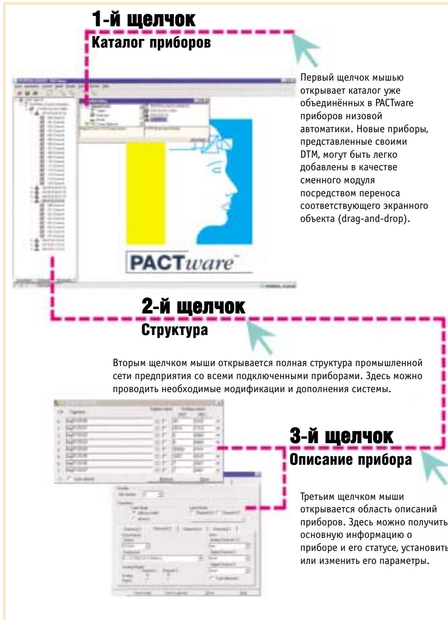
Рис. 2. Порядок модернизации и дополнения PACTware: достаточно всего трёх щелчков клавишей мыши для переключения страниц «Каталог приборов», «Структура», «Описание прибора» при внесении соответствующих изменений
