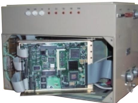
Рис. 7. Одноплатный компьютер PC-510 — основа бортового контроллера
