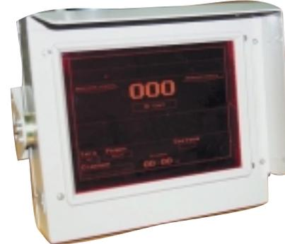
Рис. 8. Установка плоскочпанельного дисплея Planag в эргономичном конструктиве
