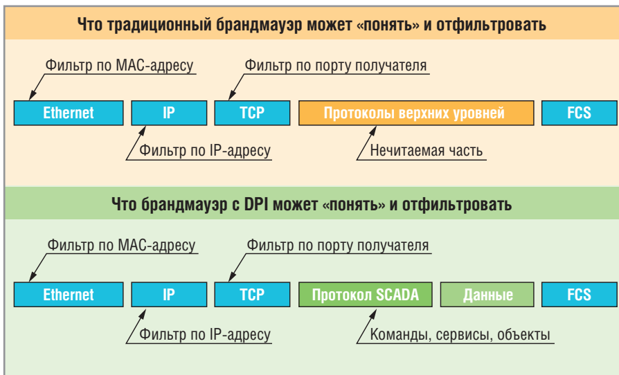
Рис. 1. Сравнение возможностей по фильтрации трафика традиционным брандмауэром и брандмауэром с DPI (традиционный брандмауэр не понимает протокола передачи данных SCADA-системы, поэтому соответствующий трафик можно только запретить или разрешить целиком)
