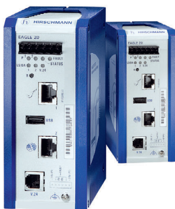
Рис. 4. Внешний вид программно-аппаратного комплекса защиты промышленного IT-контура с реализацией DPI-технологии Hirschmann EAGLE Tofino
