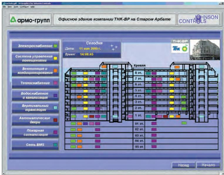
Рис. 3. Экранная форма визуализации систем управления ИЗ
