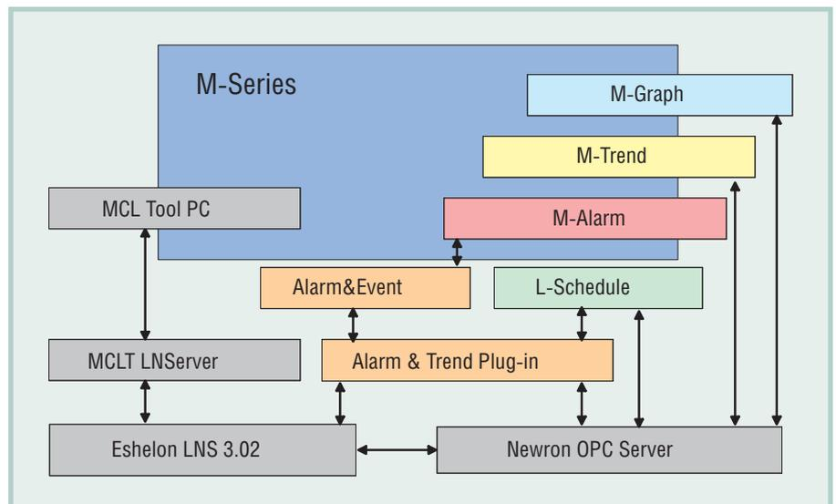
Рис. 2. Структурная схема построения рабочей станции M-Series
