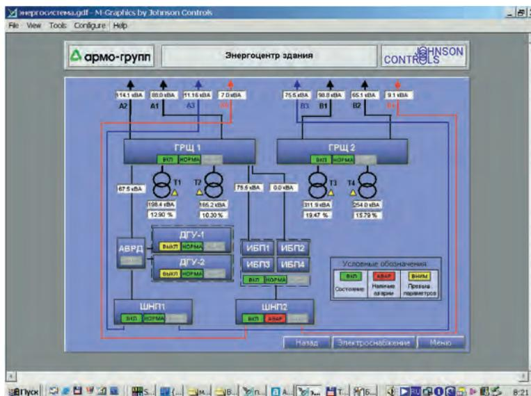
Рис. 5. Мнемосхема автономной системы управления бесперебойным энергоснабжением
