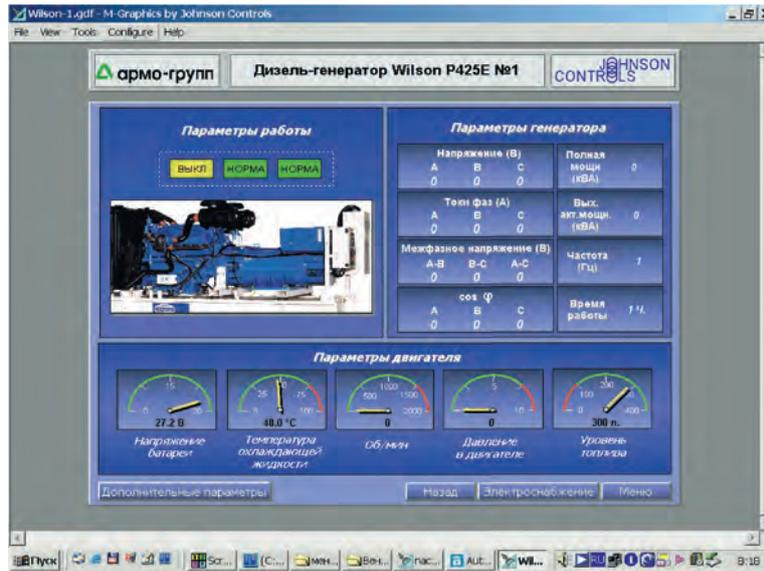
Рис. 6. Копия экрана автономной системы управления бесперебойным энергоснабжением
