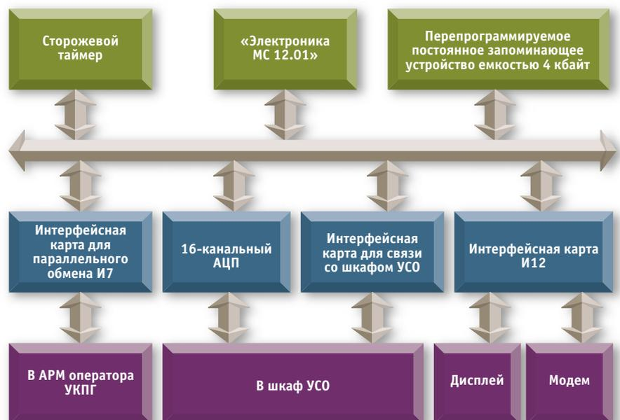
Рис. 2. Структурная схема управляющей ЭВМ «Электроника-60»
