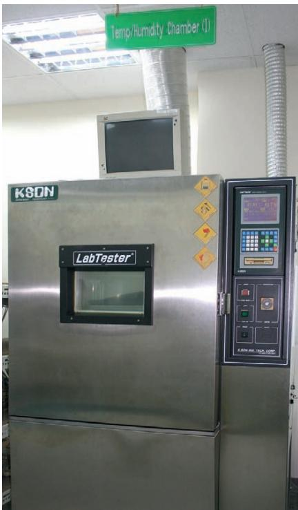
**Рис. 2. Стенд для проведения температурного тестирования**
