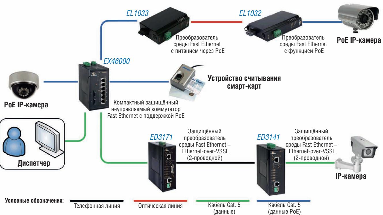
Рис. 5. Пример возможного применения коммутатора с поддержкой PoE
