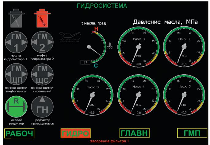
Рис. 7. Аварийное сообщение на экране гидросистемы
