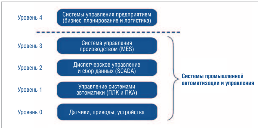
Рис. 2. Схема уровней системы промышленной автоматизации и управления
