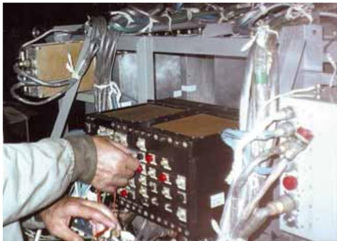
Рис. 3. Электронный блок прибора ABC-Φ на этапе сборки бортовой аппаратуры спутника
