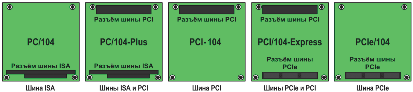
Рис. 1. Основные отличительные особенности модулей различных форматов, относящихся к семейству PC/104
