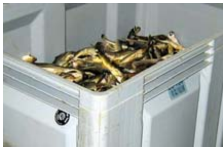
Рис. 7. Тара для посола рыбы, имеющая RFID-метку и этикетку со штрих-кодом
