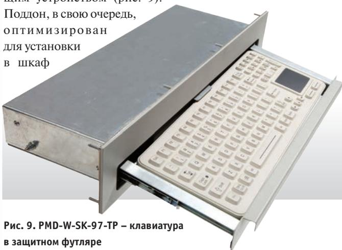
Рис. 9. PMD-W-SK-97-TP – клавиатура в защитном футляре
