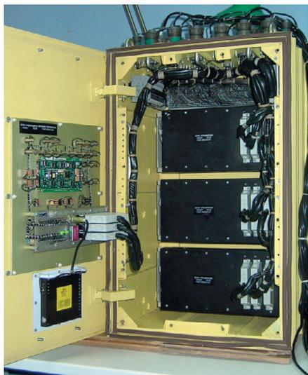
Рис. 2. Прибор управления электрокомпрессором и блоком осушки
