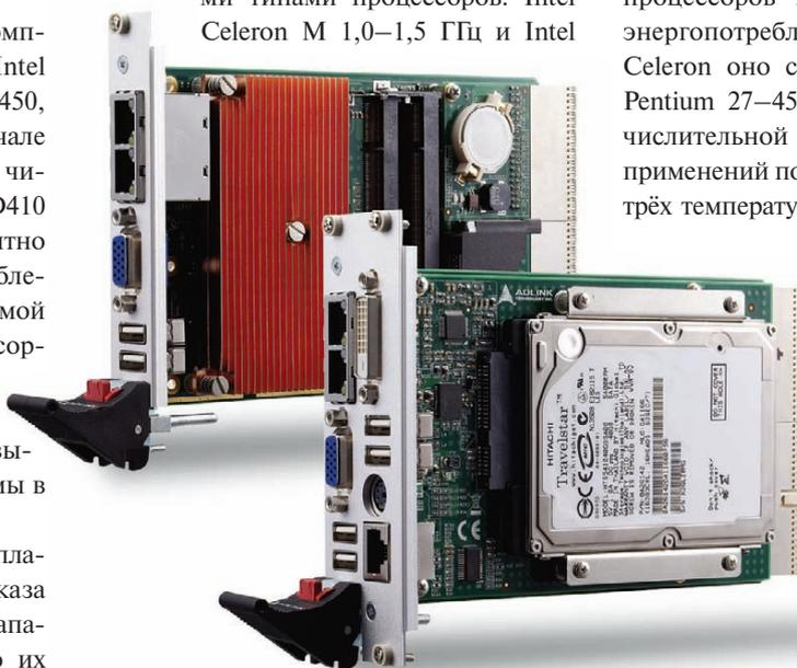
Рис. 3. Две модификации sPCI-3965
