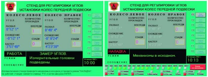
Рис. 6. Копия экрана монитора в автоматическом режиме работы стенда Рис. 7. Копия экрана монитора в ручном режиме работы стенда
