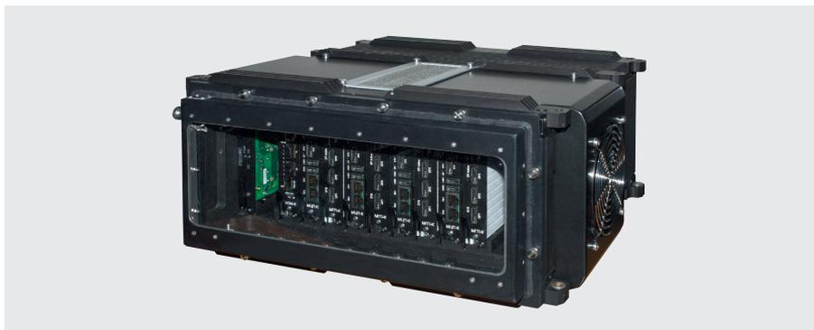
Рис. 3. Исполнение платформы с гибридным отводом тепла
