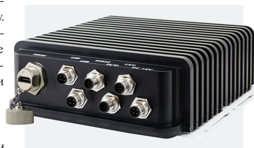
Рис. 10. Ультразащищённый встраиваемый ПК AdvantiX ERX-50
