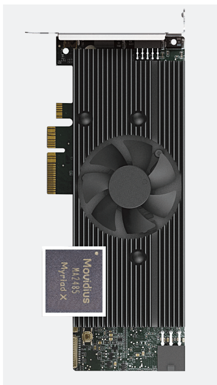
Рис. 6. Mustang V100-MX8 с Intel Movidius VPU
